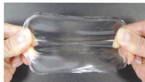
乾後形成透明彈性薄膜，阻隔水份及水氣。
